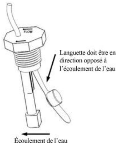
Utilisez les unions fournies et serrer manuellement aux deux extrémités de la cellule pour une parfaite étanchéité. Pour piscine ou du spa avec des systèmes à débordement, utiliser le schéma n ° 2 ou n ° 3 ci-dessous pour permettre que la chloration soit fonctionnelle à la fois pour la piscine et le spa pendant le débordement, mais lorsque vous utilisez le spa seulement elle permet d'éviter la sur-chlorination.
